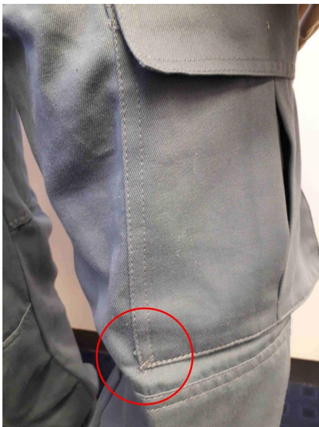
Εικόνα 14. Ενίσχυση ραφών τσέπης παντελονιού
